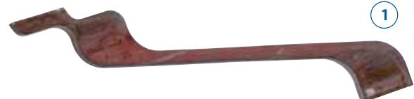
(2) ... عملیات کوبیدن داغ قطعات بریده شده پروفیل در کوره ها تا دمای پیشنهاد شده داغ می شوند و قبل از کوبیدن به شکل گذاخته شده در می آید. زیر ضربه های چکش های چند تنی به فولاد شکل داده می شود. تراشه ها و قسمت های زائد ایجاد شده در این مرحله در مراحل بعدی با کمک پرس ها حذف می گردند.
