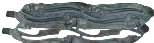
(2) در قالب آهنگری دوبل، آهنگری گرم شده است. سوالفه اضافی تحت یک پرس لنگ برداشته می شود.
